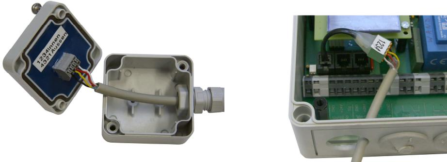
Die abisolierten Drahtenden der Steuerleitung werden in die Klemmen am Sensor eingesteckt. In die Klemmen am Adapter werden die abisolierten Drahtenden vom anderen Ende der Leitung so eingesteckt, wie es der Einsatzzweck vorsieht:
