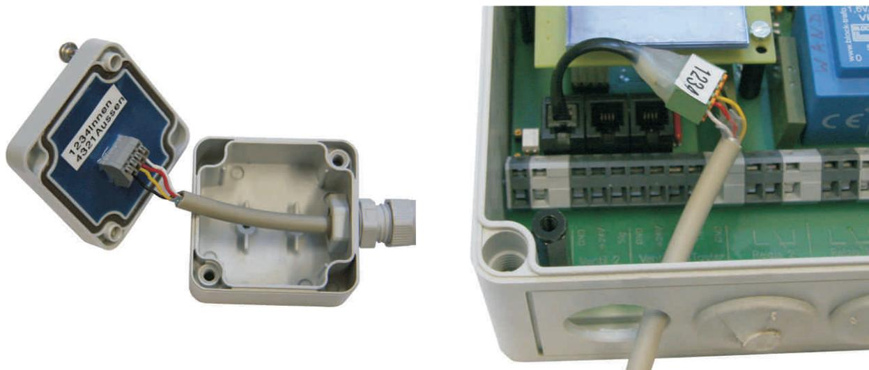
Die abisolierten Drahtenden der Steuerleitung werden in die Klemmen am Sensor eingesteckt. In die Klemmen am Adapter werden die abisolierten Drahtenden vom anderen Ende der Leitung so eingesteckt, wie es der Einsatzzweck vorsieht:
